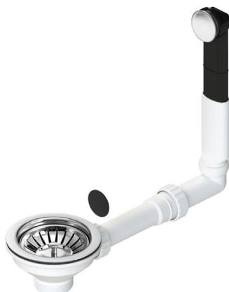
Piletta D. 114 mm per lavello con foro D. 90 mm, tappo cestello con troppo pieno rotondo snodato con piastrina inox smart. Applicazione: inox, sintetici e ceramica. Materia plastica PP, PVC e gomma, acciaio inox AISI 304, ottone nichelato.
