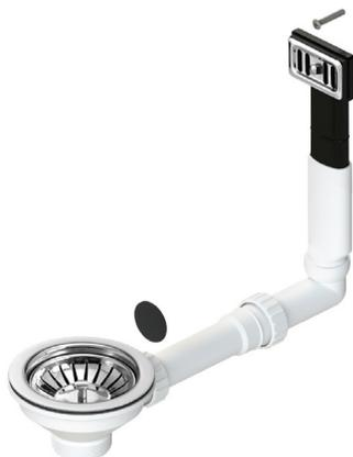
Piletta D. 114 mm per lavello con foro D. 90 mm, tappo cestello con troppo pieno rettangolare snodato. Applicazione: Inox, sintetici e ceramica. Materiali: PP, PVC, gomma, acciaio inox AISI 304, ottone nichelato.
