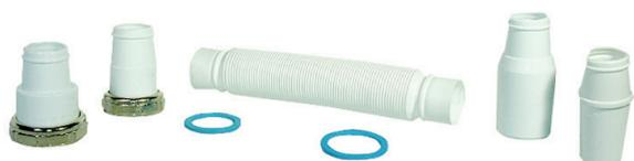
Kit composto da Nr.1 Tubo dn32, Nr.1 Raccordo 1"1/4 , Nr.1 Raccordo 1"1/2 , Nr.1 Imbuto dn32 , Nr.1 Imbuto dn40. Per la saldatura dei raccordi al tubo basta frizionare il raccordo nel tubo fino a farlo riscaldare, si bloccherà automaticamente.
