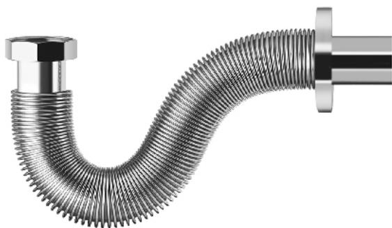
In acciaio INOX AISI 304. Estensibile da 300 a 450 mm. Ghiera in ottone cromato da 1"1/4. Guarnizione con bordo di sicurezza in NBR. Rosone in acciaio. Portata: passaggio totale. Applicazione: lavabo, bidet, lavello. Tipo di installazione esterna. Temperatura min. -30°C. Temperatura max. +90°C. Innesto tubo: D. 32 mm. Finitura acciaio lucido.
