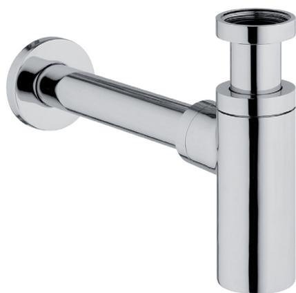
Materiale: Tutto in ottone. Tubo orizzontale: L=Max.290 mm. Tubo verticale: L=Max.130 mm. Utilizzo: Adatto per lavabo 1"1/4. Tappo di ispezione: Presente sul fondo. Attacco sifone al lavabo: 1"1/4. Uscita: Tubo D.32 mm con rosetta.
