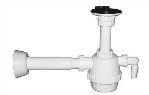
Sifone dotato di un canotto speciale che collega il sifone con ingresso diam. 32, allo scarico a muro con uscita diam. 40. Il corpo sifone rimane solito, con ingressi da diam. 32.
