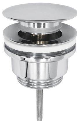
Piletta click-clack per lavabo, con tappo coprente in ottone pesante lusso, fissaggio con vite per spessori igienici universali in ceramica e vetro da 0 a 70 mm con e senza foro troppo pieno. Dotata di regolazione chiusura tappo.
