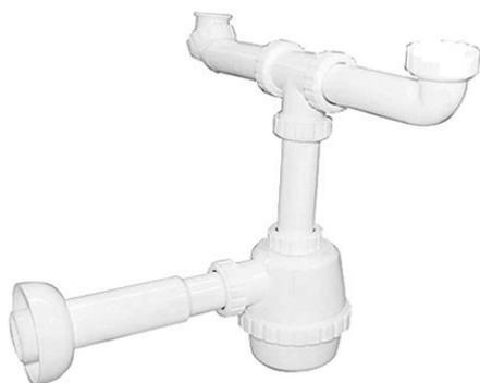
Sifone dotato di un canotto speciale che collega il sifone con ingresso diam. 32, allo scarico a muro con uscita diam. 40. Il corpo sifone rimane solito, con ingressi da diam. 32.
