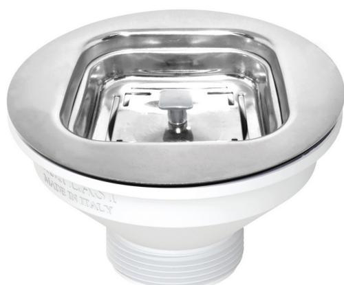
Piletta D. 114 mm per lavello con foro D. 90 mm. Tappo cestello quadrato. Applicazione: inox e sintetici. Materiale: PP, PVC e gomma. Metalli Acciaio inox AISI 304, ottone nichelato.
